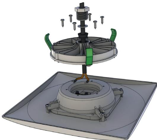
Mise en place des cosses sur les connecteur puis serrer fermement les vis.
