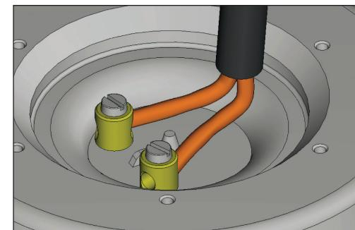
Mettre les fils dans les connecteur, serrer fermement les vis.
