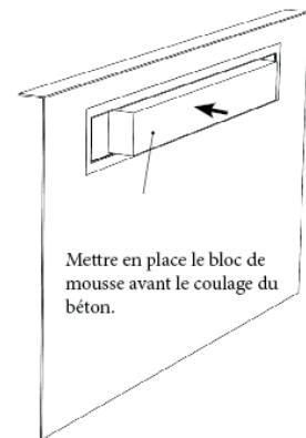
Mettre en place le bloc de mousse avant le coulage du béton.
