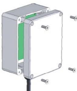
4a) 4 Schrauben lösen und Abdeckung der Kontrolleinheit entfernen.
