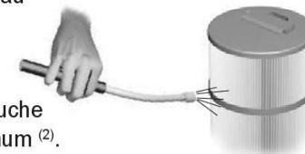
La durée de vie de la cartouche est d'environ deux saisons, selon l'utilisation et la fréquence de nettoyage. Il est conseillé d'utiliser un jeu de deux cartouches pour éviter d'immobiliser le filtre pendant l'opération de nettoyage.
