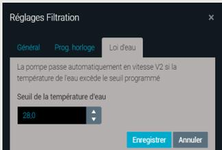
*La filtration AUTO avec une pompe normale et une pompe à vitesse variable est différente. Ce mode déclenche la filtration pour une durée optimale selon la T°eau mesurée selon différents paramètres :*
